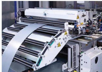
Schuler aynı zamanda ideal malzeme kullanımı için yüksek dinamik zig zag silindirik beslemesi PowerFeed'i de tedarik ediyor.
