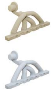
Resim 2: Boyanmış ve boyanmamış maçaların karşılaştırılması
