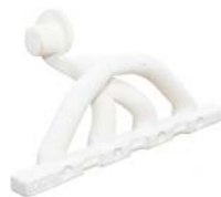
Resim 6: Çelik için boyanmış maça
