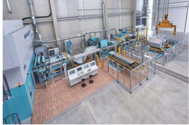
Mercedes-Benz kompakt araçları için devamlı beslenen çelik ve alüminyum plakalardan dış kaporta boşlarını kesiyorlar.
