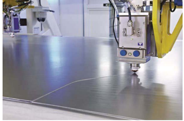
Schuler'in Dinamik Akış Teknolojisi, çalışan materyal hattında eş zamanlı kesim için üç fiber lazer kullanıyor.
