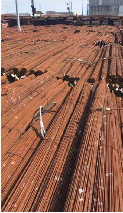
Resim: Türkiye'ye Ulaşan İthal Standart Dışı, Paslanmış İnşaat Demiri
