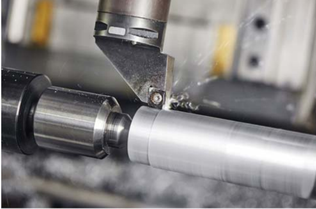
Resim 1. Tornalama sırasında, silindirik çelik iş parçası tornatezgahında yüksek hızda döndürülür.
