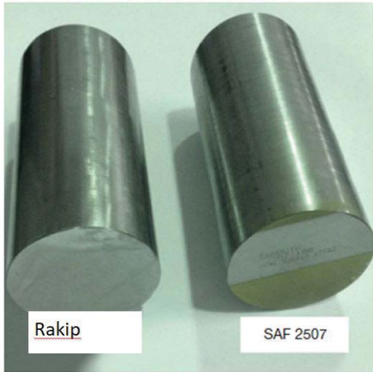
Şekil 2. Dolu çubuk (solda) ve kalın etli boru Sandvik SAF 2507 ve rakip süper duplex
