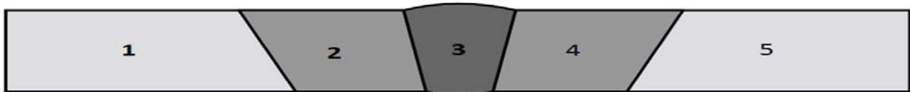
Şekil 5. Sertlik testi yapılan bölgeler
