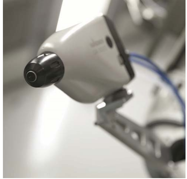
Kontur lazer tarayıcı tarafından tespit edilen tam nesne geometrisi, 3D yazılım ile denetleyici tarafından otomatik olarak çevrilir, tabanca eksenleri buna göre yerleştirilir ve kaplama parametreleri otomatik toz boyama için ayarlanır.
