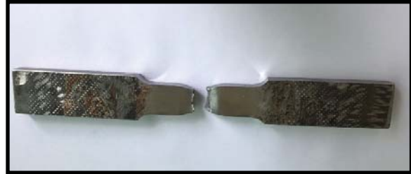
Şekil 1. Deney öncesi ve sonrası kaynak bölgesinde kırılma davranışı
