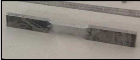
Şekil 1. Deney öncesi ve sonrası kaynak bölgesinde kırılma davranışı
