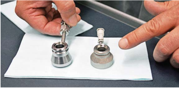
Şekil 17. Katmanlı imalat yöntemi ile üretilen yağ başlığı (sağda görülen) [21].
