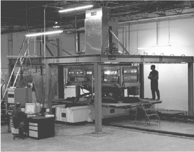
Şekil 9. AeroMet Corporation/ARL'nin ticari ölçekteki lazer şekillendirme/biriktirme sistemi [6].
