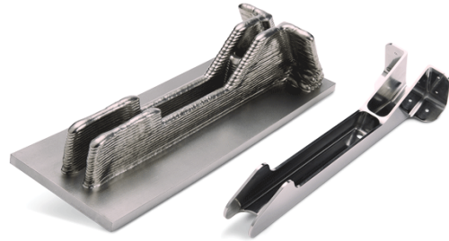
Şekil 19. Boeing 787 Dreamliner için üretilen titanyum parçalar [21].
