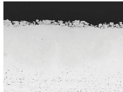
Şekil 4. AA7075-T651 alaşımı üzerine Al-%12Si tozu kaplama.
