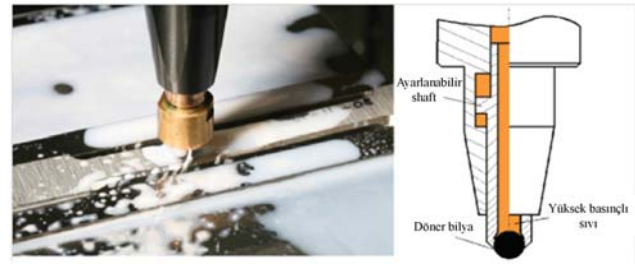
Şekil 7. Lazer kaplamalı numunelerin derin yüzey haddeleme işlemi [5].
