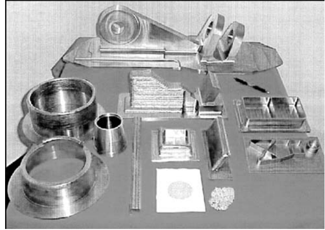
Şekil 10. Lazer şekillendirme yöntemi ile üretilmiş ve işlenmiş parçalar [6].
