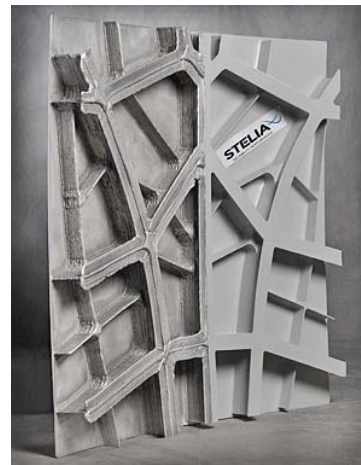
Şekil 16. STELIA Havacılık firmasının ürettiği 1m²’lik alüminyum panel [21].
