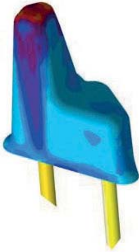
Figür 3: Soğutma kanalları içerisinde ve kalıp çevresinde soğutma akışı analizi
