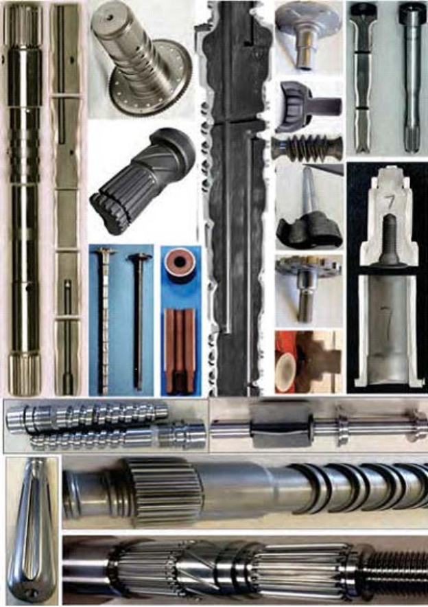
Şekil 2: Mil benzeri bileşenlerdeki çeşitli parça geometrilerine örnekler.
