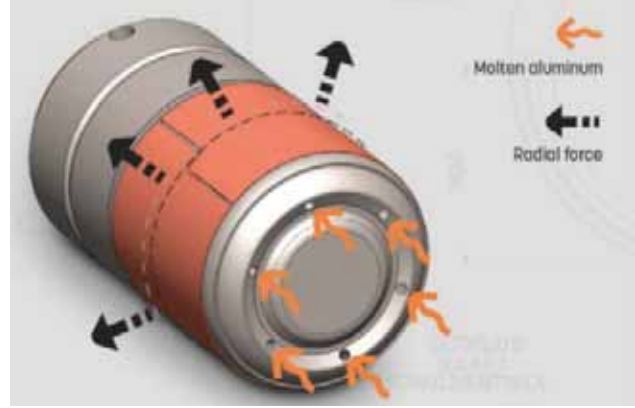
COPROMEC® ring, piston ve hazne arasındaki boşluğu kompanse ederek, hazneyi korur!
