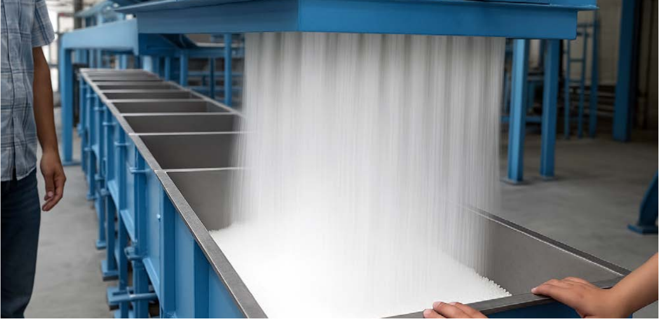
Lost Foam (Kayıp Köpük) Prosesinde Strafor Modelin Oluşturulması
