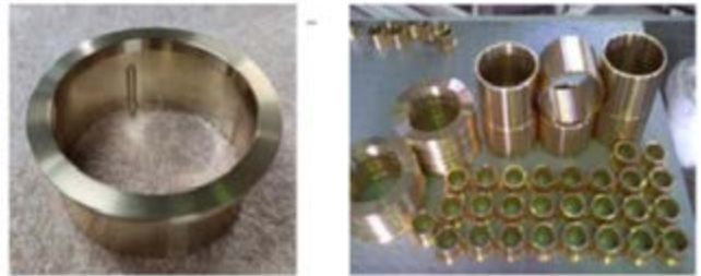
Şekil - 3: Havacılık sistemlerinde yaygın olarak kullanılan bronz alaşımlı burç ve yatak komponentleri
