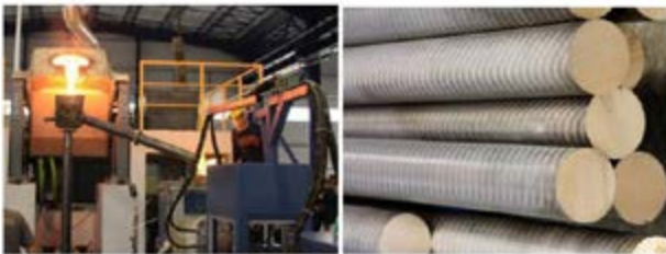
Şekil - 6: Sürekli döküm yöntemi ve süreç sonunda elde edilen bronz çubuk ürünler
