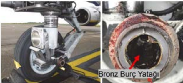
Şekil - 2: İniş takımı tekerlek aksının iç mil yatağı bölgesinde tespit edilen yapısal arıza [4]
