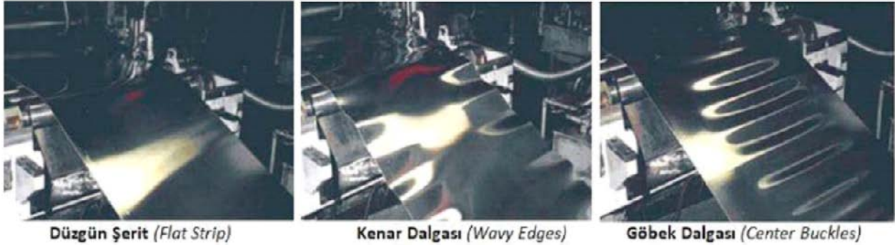
Şekil -3.4: Soğuk haddelemede malzeme hataları
