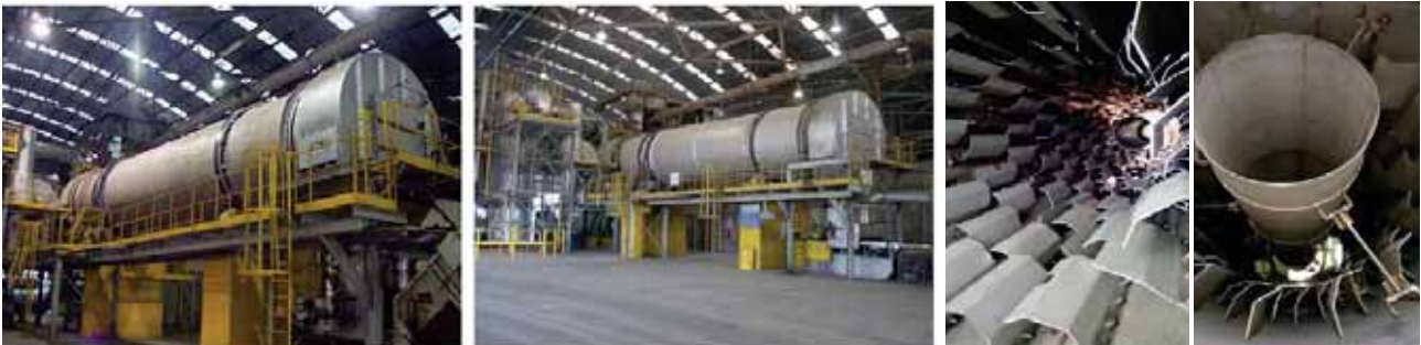
Şekil 9: Döner boya-lak yakma fırını (Insertec)
