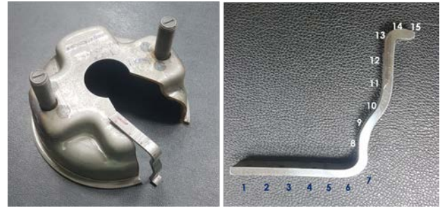
Şekil 2: Derin çekme numunesinden alınan kesit parçası ve sertlik ölçüm noktaları
