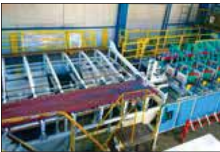
Türkiye'nin İlk ve Tek Rulman Üreticisine Iductotherm'den Yerli Üretim 1500kW'lık Çubuk Isıtma Sistemi
