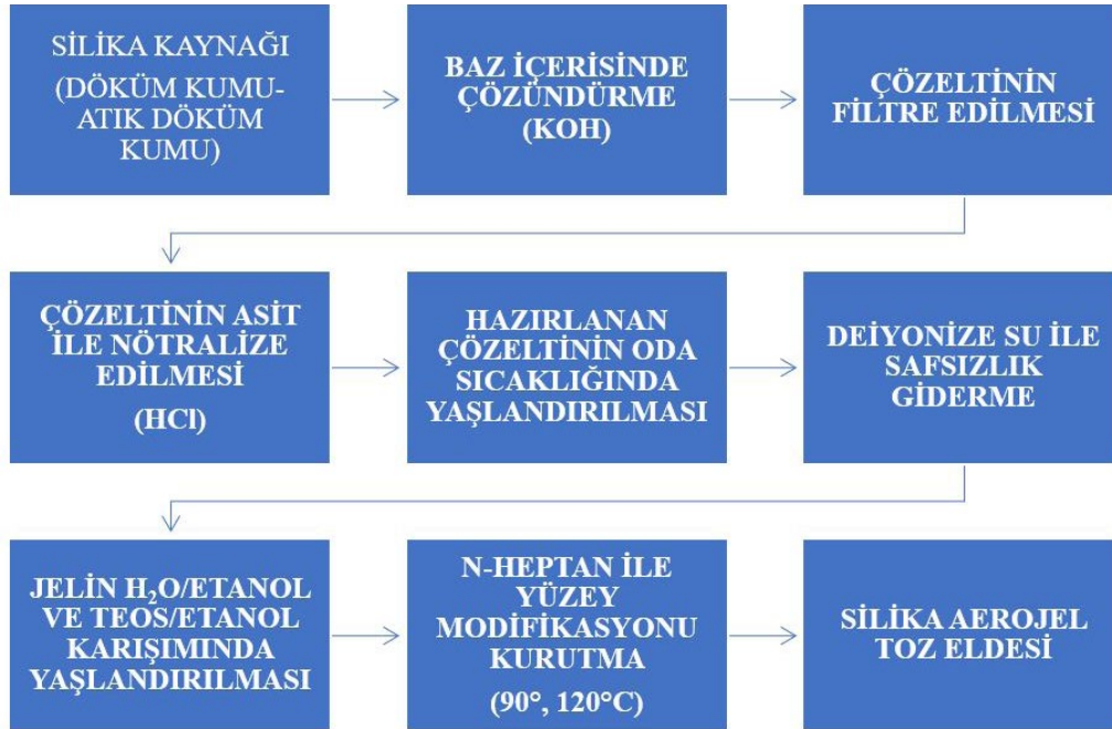
Şekil 1: Silika esaslı aerogel toz eldesi üretim akış şeması
