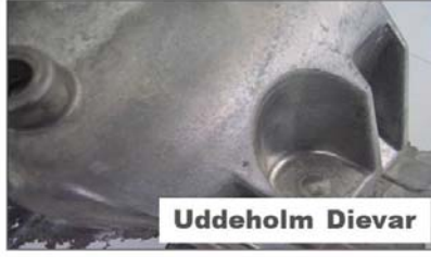
95.000 baskı sonrası H13 ESR ve Dievar 25 Joule karşılaştırması.
