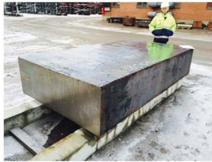
3 Boyutlu olarak dövülmüş DIEVAR blok 640mm kalınlık 1280 mm genişlik 18 ton ağırlığında olup 28 Joule tokluk değeri göstermiştir.
