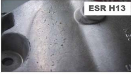
95.000 baskı sonrası H13 ESR ve Dievar 25 Joule karşılaştırması.
