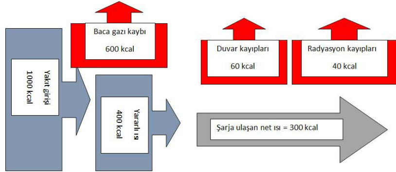
Şekil 1: 980 °C'de tipik fırın enerji balansı (ısı geri kazanımı olmadan):
