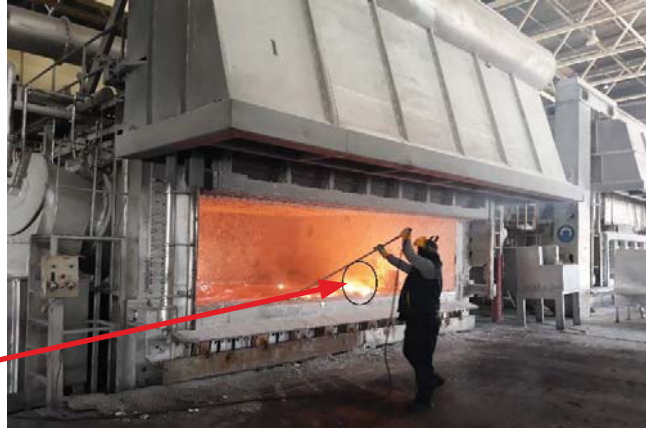
Şekil 3: Magnezyumun oksidasyonu: taç magnezyumun indüksiyon fırınında ergimesi ve metalik magnezyumun ergimiş alüminyuma verildikten sonra azotla karıştırma işlemi
