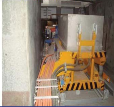
Şekil 5: Tabana monte edilmiş elektromanyetik karıştırıcı (ABB)
