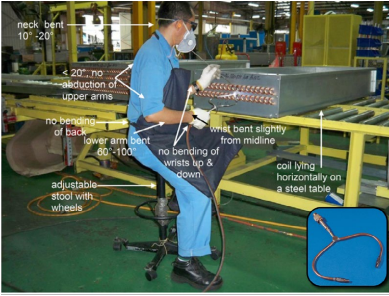
Şekil 11: Çift-alevli ay-şaloma (sağ-altta, Twin-Brazing Torch, TBT) kullanılarak bakır U-boruların alüminyum radyatöre sert lehimlenmesinde (seri-imalat), iş sağlığı ve güvenliği bakımından ergonomik duruş [29]; neck bent 10°-20°: boyun büküm açısı 10°-20°; <20°, no abduction of upper arms: üst kolların açıklık açısı <20°; no bending of back: sırt bükülmez; lower arm bent 60°-100°: alt kolların büküm açısı 60°-100°; no bending of wrists up & down: bilekler yukarı & aşağı bükülmez; wrist bent slightly from midline: bilek ekseninden hafifçe bükülmüş; adjustable stool with wheels: ayarlanabilir tekerlekli tabure; coil lying horizontally on a steel table: çelik masa üzerine yatırılmış alüminyum radyatör
