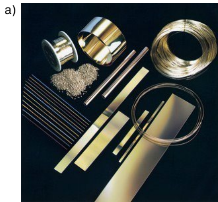
Şekil 5: Lehim ilave metali türleri. a) Çubuk, şerit, levha, tel, toz şeklindeki lehim ilave metalleri, b) Preform/insert, pasta (lehim pastası ile lehim ilave metali tozunun karışımı) vs. şeklindeki lehim ilave metalleri [20].
