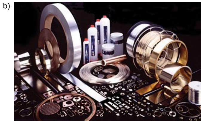
Şekil 5: Lehim ilave metali türleri. a) Çubuk, şerit, levha, tel, toz şeklindeki lehim ilave metalleri, b) Preform/insert, pasta (lehim pastası ile lehim ilave metali tozunun karışımı) vs. şeklindeki lehim ilave metalleri [20].
