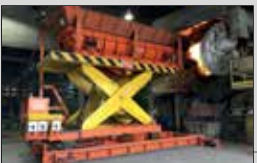
Fırın Yükleyicileri / Furnace Charger
