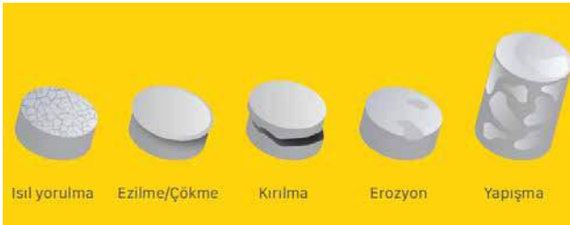
Şekil 1: Metal enjeksiyon kalıplarında hasar mekanizmaları
