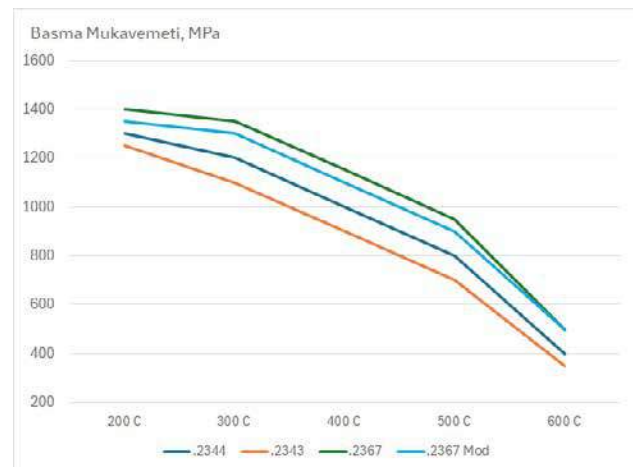
Şekil 6: Bazı sıcak iş takım çeliklerinin sıcaklık v Mukavemet ilişkisi*
