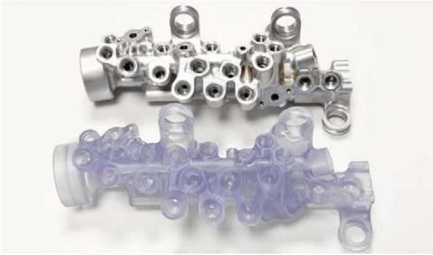
Şekil 6: Renault F1, Hidrolik manifold; CNC makinada işlenmiş, 3D yazıcıda üretilmiş. [9]
