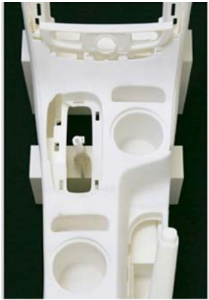
Şekil 9: Chevrolet vites kutusu konsolu, 3D yazıcıda üretilmiş (a), montajı tamamlanmış son durumu (b) [12].
