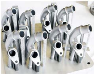
Şekil 7: Audi W12 3D motoru su konektörü [10].
