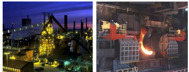
Şekil 3: Günümüzün modern bir yüksek fırının (YF) genel görünümü ve sıvı ham demir şarjı yapılan bir bazik oksijen konverteri (BOF).
