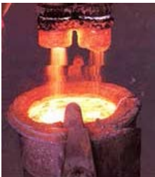
Şekil 2: (a) Potanın içindeki sıvı ham demirin yüzeyine oksitleyici gaz üflenerek karbonun azaltılması işlemi yerine (b) Sıvı ham demirin içinden sıcak hava geçirerek karbonu azaltan Bessemer konverteri.
